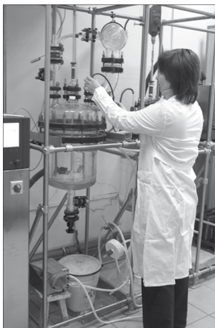
Получение форполимера в отделе органического стекла
